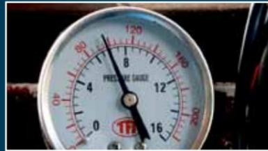
A través de una poderosa bomba se incrementa el ritmo de producción de agua pura cuando se esta procediendo al llenado del deposito. Todos los sistemas de osmosis inversa se muestran mucho más eficaces con un nivel de presión más elevado, y es así porque el proceso depende de la diferencia de presión que se da en ambos lados de la membrana. Cuanta más presión se produzca, mayor será la producción de agua pura.
